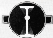
Centralrör med invändig stålprofilförstärkning.
